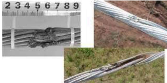
Figura. N.º 7. Mantenimientos de conductores Fuente: autor
